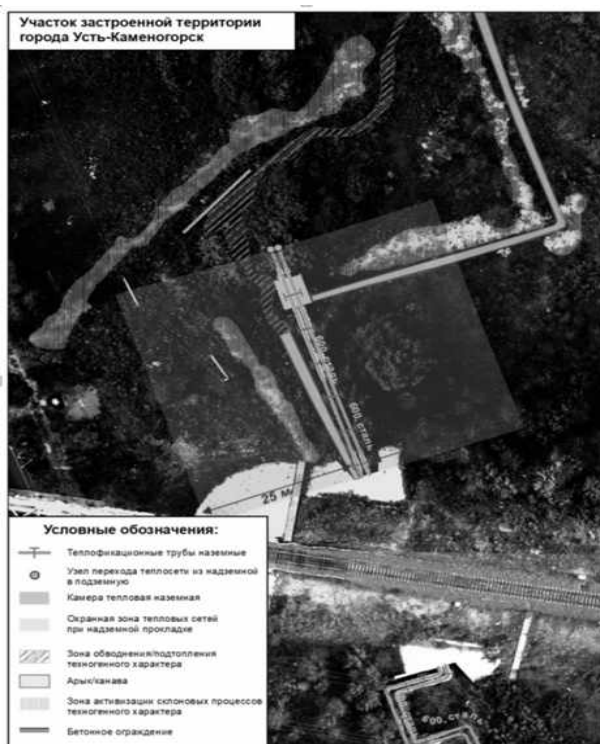
Рисунок 2. Участок застроенной территории города Усть-Каменогорск с подтоплением охранной зоны теплотрассы вдоль перехода надземной прокладки в подземную
